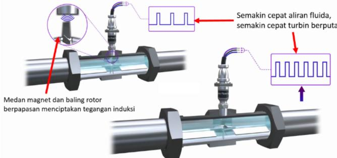
جريان سنج توربینی یک نوع دستگاه اندازه گیری است که استفاده از آن در صنعت نفت و گاز خیلی مرسوم است. اغلب این نوع جريان سنج به دیگر جريان سنج ها به دليل مزايايي نظير سادگي در نصب و دقت بالاي آن در اندازه گيری ترجيح داده مي شود. به همين دليل از اين دستگاه اغلب برای اندازه گيری مواد با ارزش مثل نفت خام، گاز و همچنين فراورده هاي نفت خام استفاده مي شود. اين نوع دبي سنج از نوع دبي سنج هاي سرعتي مي باشد که سرعت جريان سیال را اندازه گيری مي کند.
